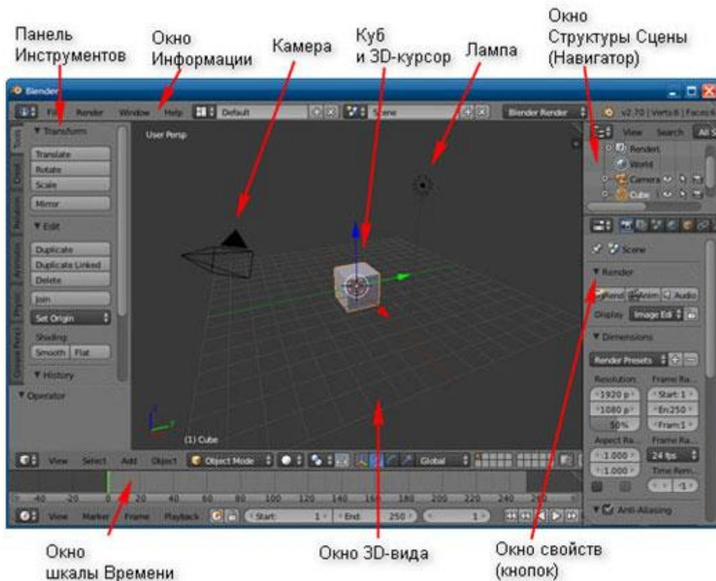
В 3D окне можно наблюдать две пересекающиеся в центре линии (красную и зелёную) – оси координат X и Y (их обозначения есть в нижнем левом углу 3D-окна), 3D-курсор, куб, лампу и камеру.
